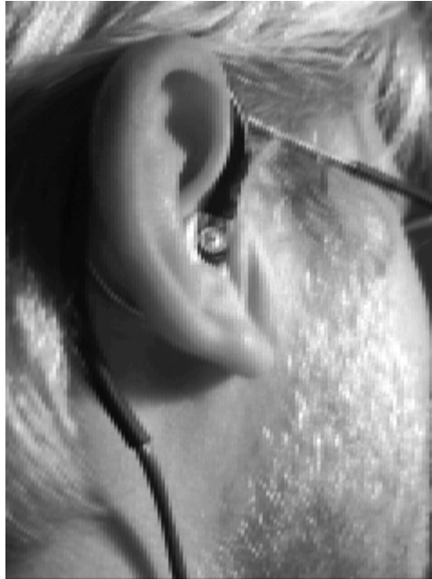
Kuva 3.1 Mikrofonin pysyy hyvin paikoillaan korvan taakse menevän sangan ansiosta. Sankojen vaikutus äänikenttään äänenlaadun arvioinnin kannalta kiinnostavalla taajuusalueella on useimmissa tapauksissa merkityksetön.
