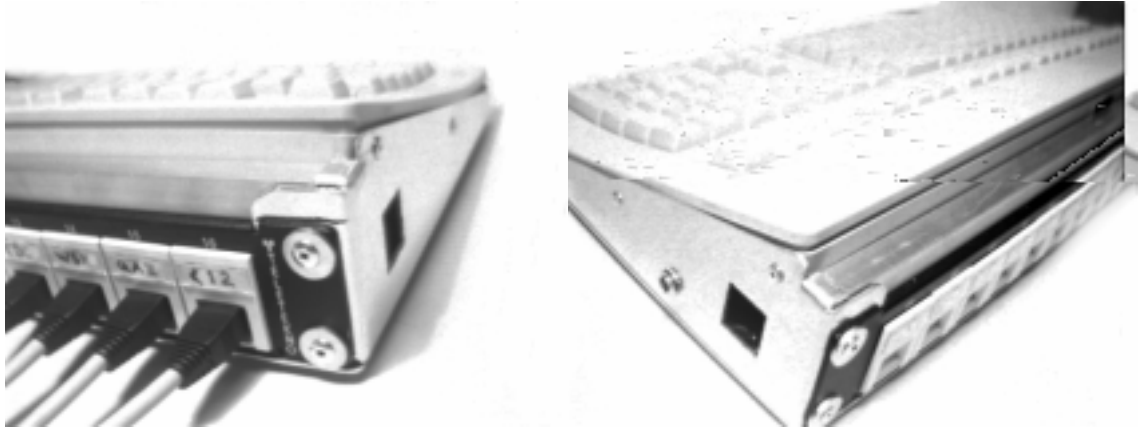
Kuva 3.5 Kuuntelukoejärjestelmää varten muunneltu Apple ® xtended Keyboard. Hiiret liitetään näppäimistön taakse lisättyyn liitinpaneeliin. Näppäimistö on edelleen ketjutettavissa Macintosh ® Desktop Bus:in kautta (aukko näppäimistön päädysssä). Mikäli hiirien L D-merkkivaloja halutaan ohjata, täytyy näppäimistöön liittää ulkoinen virtalähde.
