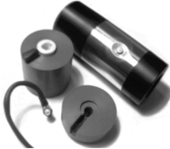
Kuva 2.10 Suunnittelimme PVC-muovista sorvattu adapteri tosipää-mikrofonin kalibrointiin Brüel&Kjær:n kalibraattorille 4230.
